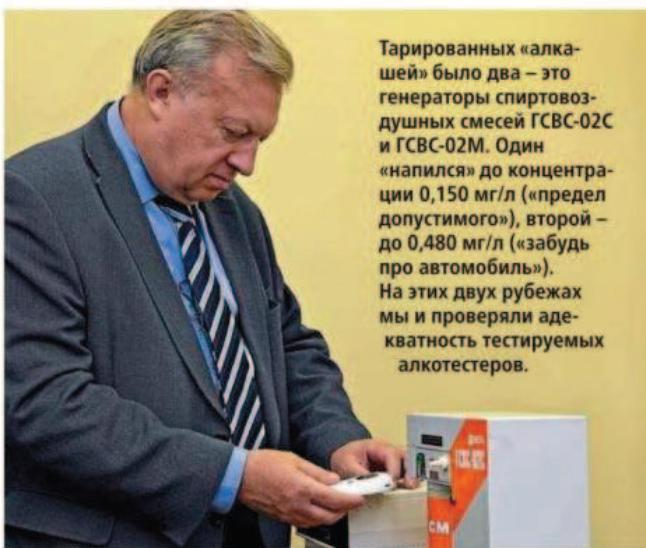
Тарированных «алкаш» было два – это генераторы спиртовоздушных смесей ГСВС-02С и ГСВС-02М. Один «напился» до концентрации 0,150 мг/л («предел допустимого»), второй – до 0,480 мг/л («забудь про автомобиль»). На этих двух рубежах мы и проверяли адекватность тестируемых алкотестеров.
