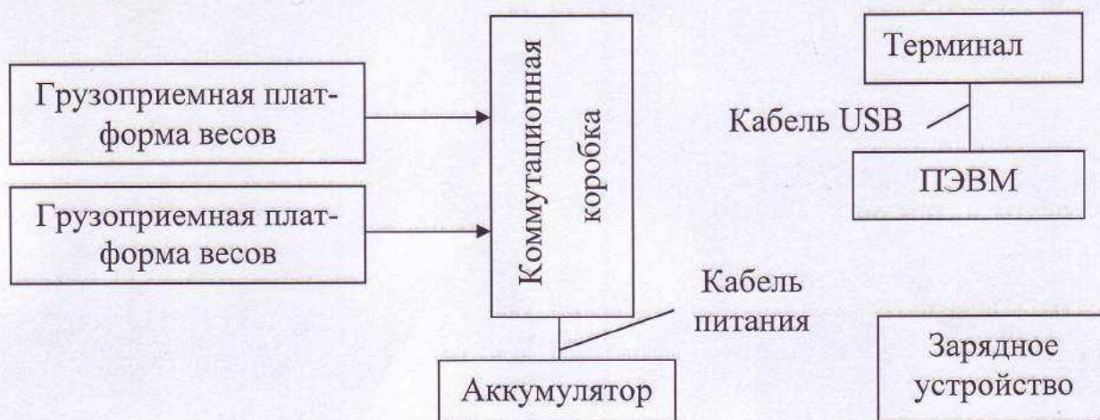
Рисунок 3б – Схема подключения весов при беспроводном соединении
