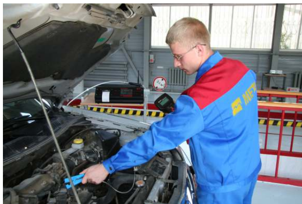
Многокомпонентный газоанализатор АВТОТЕСТ для измерения концентрации CO, CO 2 , CH, O 2 , NO x , частоты вращения коленчатого вала при проверке токсичности отработавших газов автомобилей
