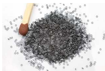
Миниатюрные кольца ППГ для МЗУ С-300 «Тополь» весом 0,11 мг D 0,8 мм.
