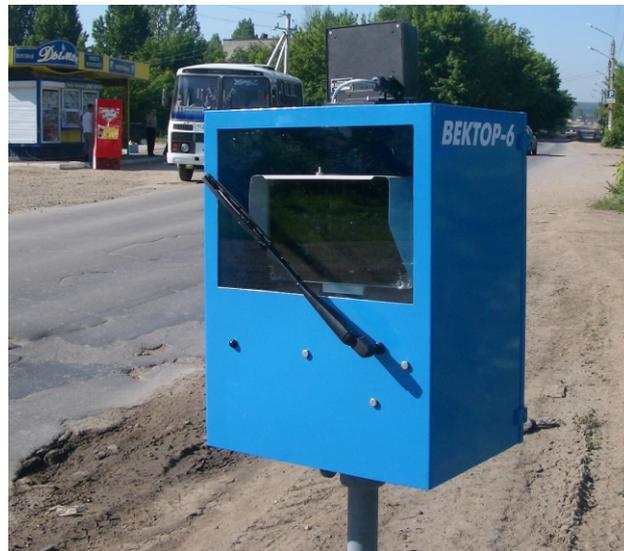
Стационарный и передвижной комплексы оснащены оборудованием для передачи фотоинформации по радиоканалу высокочастотной связи 1,2 ГГц (устойчивая дальность 6-7 км) или GPRS-модемами для получения информации на пунктах управления.
