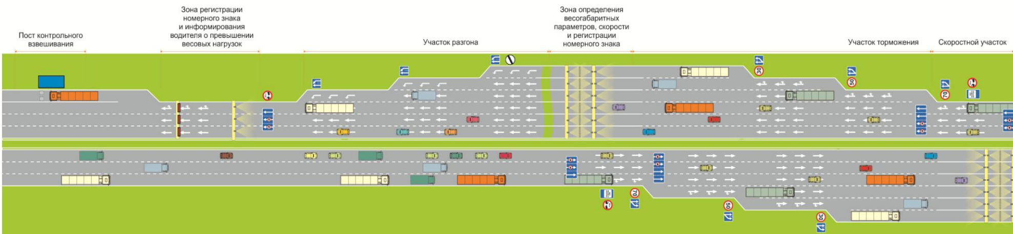
Вариант II организации автоматизированного комплекса определения весогабаритных параметров транспортных средств в движении
