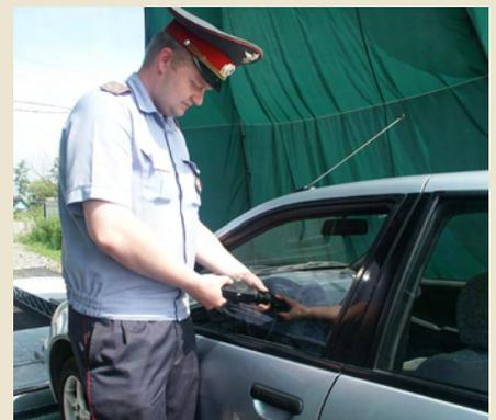
Измеритель светопропускания стекол ТОНИК
