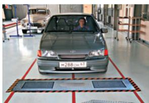
Тестер предназначен для контроля состояния амортизаторов. Позволяет объективно оценить способность подвески воспринимать нагрузку и возвращаться в исходное положение, а так же, выявить склонность автомобиля к «уводу» при верных углах установки колес.
