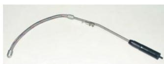
Пробозаборный зонд газоанализатора с защитной оболочкой из нержавеющей плетенки со встроенным фильтром предварительной очистки пробы
