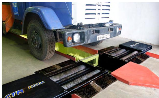
*ЛТК-С 15000 У— автоматизированная универсальная линия технического контроля для легковых и большегрузных автомобилей, а так же автобусов всех категорий с осевой нагрузкой до 15000 кг*
