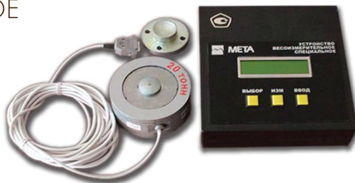
УВС предназначен для поверки малогабаритных переносных автомобильных весов по колесному взвешиванию по ГОСТ 29329.
