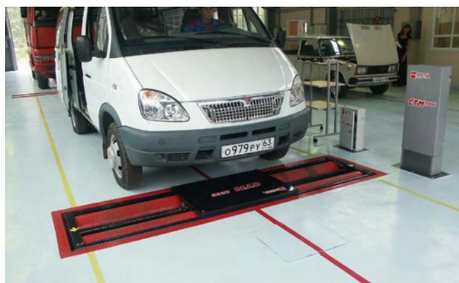
*ЛТК-С 8000 - линия технического контроля для проверки технического состояния грузовых и легковых автомобилей, а также микроавтобусов с нагрузкой на ось до 10000 кг*
