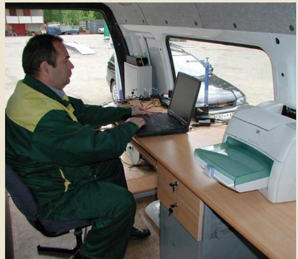
В настоящее время компания МЕТА серийно выпускает мобильный бесфундаментный стенд СТМ-3500М-Н, который можно перевозить в прицепе, выполняя проверку тормозной системы ТС фактически в любых условиях. Прицеп оснащен дизель-генератором, что позволяет сделать диагностическую станцию полностью энергонезависимой.
