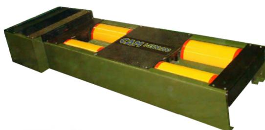
НПФ МЕТА серийно производит одноосный динамический мощный роликовый стенд СДМ 1-3500.200., преимуществом которого является новое конструктивное решение – замена электропривода на индукционный тормоз, что при незначительном изменении функциональных возможностей стенда значительно снижает стоимость.
