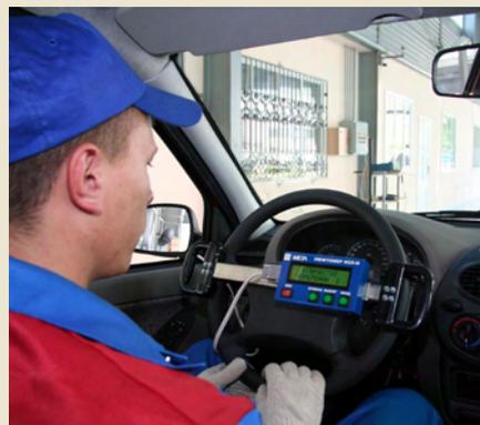
Измеритель суммарного люфта рулевого управления ИСЛ-М
