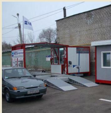
**ЛТК-М** – мобильная станция диагностики контейнерного типа размером 6040 x2450 x2700 мм с гидроприводом подъема наездов и утепленным офисом 7,2 м<sup>2</sup> для проверки технического состояния микроавтобусов и мини-грузовиков.
