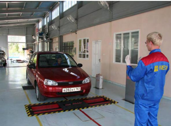
Универсальные тормозные стелды СТМ различных модификаций для диагностики автомобилей с нагрузкой на ось от 3,5 до 15 тонн.
