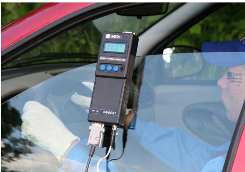
*Измерение параметров торможения по ГОСТ Р 51709– 2001 методом дорожных испытаний*
