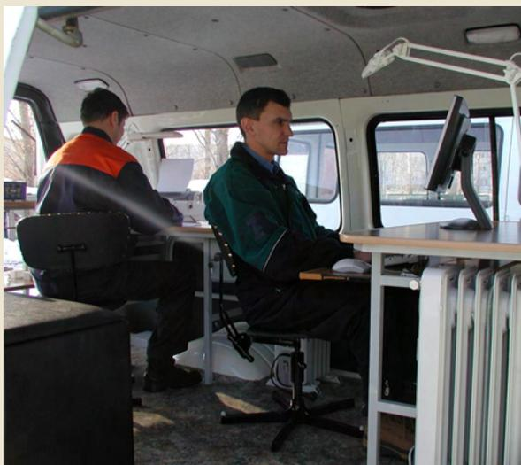
– рабочее место оператора-контролера: рабочий стол, поворотное кресло, ПЭВМ Notebook, принтер, отопитель салона, огнетушитель, медицинская аптечка и рундук для размещения т транспортировки диагностического оборудования и оргтехники.
