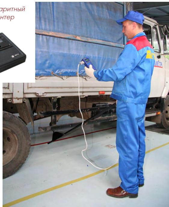
Дымомеры МЕТА-01МП 0.2Т и МЕТА-01МП 0.43Т предназначены для измерения параметров дымности тепловозов, речных и морских судов.
