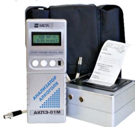
Портативный анализатор паров этанола с автономным и бортовым питанием. Позволяет произвести экспресс-анализ с принудительным отбором пробы воздуха через воронку для бесконтактного экспресс-анализа. Выпускается в двух модификациях: с клавиатурой и без клавиатуры.
