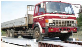
Автомобильные весы ВПА предназначены для коммерческого взвешивания автотранспортных средств в статическом режиме. Результат взвешивания выводится на цифровое табло дистанционного пульта управления и внешний дублирующий дисплей. в автомобильных весах ВПА реализована автоматическая установка нуля при включении весов, автоматическое слежение за нулем при изменении массы грузоприемной платформы за счет атмосферных осадков и загрязнения от АТС, а также сигнализация о перегрузках.
