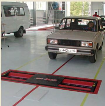
**ЛТК-С** – полный комплект диагностических приборов и тормозных стенов для проверки технического состояния легковых автомобилей и микроавтобусов.
