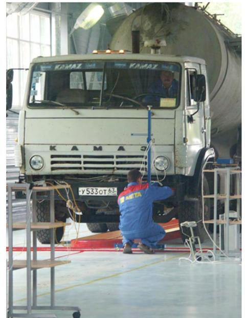
Стационарная станция технического осмотра автомобилей ЛТК-С – это компактное размещение диагностического оборудования и тормозных стенов с напольным или заглубленным размещением на производственных площадках заказчика при температуре окружающего воздуха от  $-35^{\circ}\text{C}$  до  $50^{\circ}\text{C}$ .
