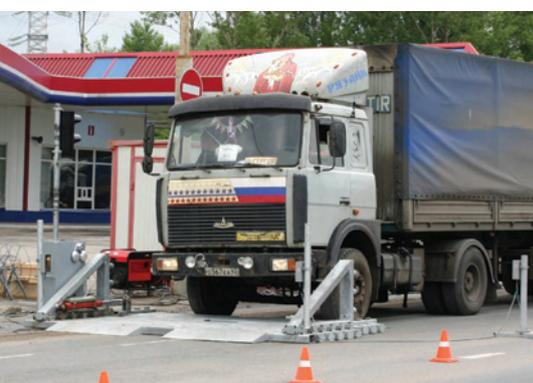
Мобильный разборный блокиратор проезда предназначен для оперативного задержания автотранспорта на дорогах и постах ДПС. Оперативный монтаж блокиратора из составных частей и установка без разрушения поверхности дорожного покрытия выполняется без применения грузоподъемной техники.
