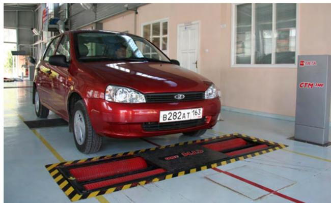
*ЛТК-С 3500 М — линия технического контроля для проверки технического состояния легковых автомобилей и микроавтобусов, в том числе полноприводных с нагрузкой на ось до 3500 кг*
