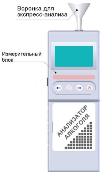
Рисунок 4 – Измерительный блок с воронкой для бесконтактного экспресс-анализа
