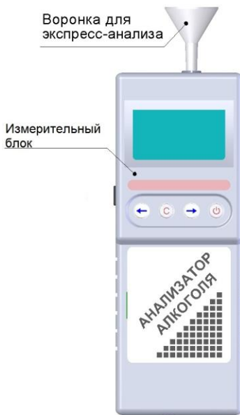
Рисунок 3 – Измерительный блок с воронкой для бесконтактного экспресс-анализа
